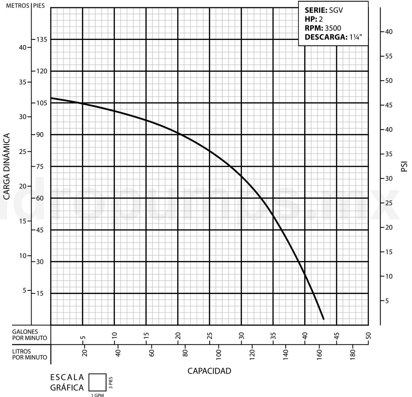
Prueba realizada con agua, gravedad específica 1.0 @ 20°C (68°F); otros líquidos pueden variar el rendimiento.
